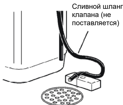
Рисунок 2: Правильное подключение слива
