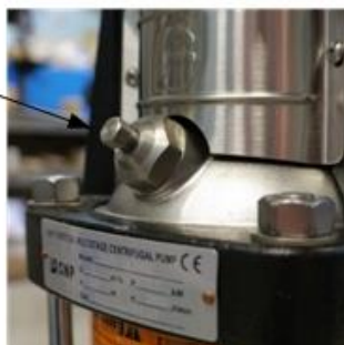
Рис. 5 Пробка на насосе для выпуска воздуха.
