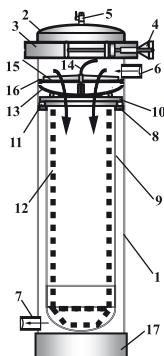
фильтра и не закрывайте его до тех пор, пока не выйдет воздушный пузырь и из-под воздухоотделителя не потечет вода.
