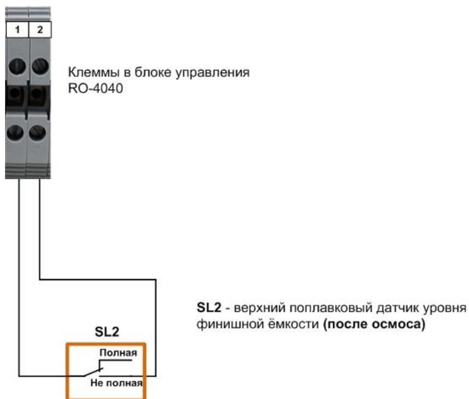
Рис. 7 Электрическая схема подключения одного датчика уровня к установке.
