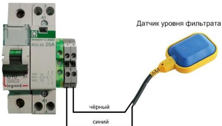
Рис. 4. Подключение датчика уровня к установке.
