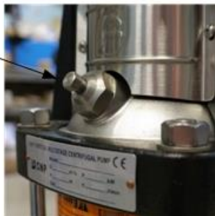
Рис. 4 Пробка на насосе для выпуска воздуха.
